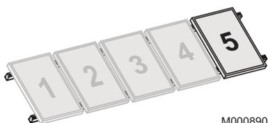
A l'extrémité de la batterie de capteurs, insérer un rail de couplage et fixer-le de sorte qu'il soit aligné avec le bord du profilé de base (ou utiliser un écrou à billes)
